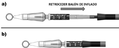
Figura 25: Configuración de navegación del sistema de colocación, con el stent descubierto de la prótesis cargado en la sección cónica de la vaina desviable: a) stent descubierto no cargado, y b) stent descubierto cargado.
